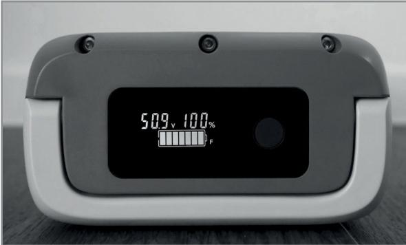
Der Akkustand wird grafisch sowohl durch ein Batteriesymbol mit 1 bis 7 Balken angezeigt als auch numerisch in Prozent. Zusätzlich wird die aktuelle Spannung des Akkus in Volt (V) angezeigt.
