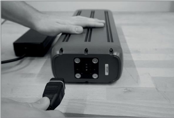
Wenn Sie ein einzelnes Ladegerät benutzen, achten Sie bitte darauf, den Stecker des Ladegeräts so zu greifen, wie im Bild unten zu sehen. Halten Sie den Stecker weder beim Einstecken noch beim Herausziehen am Kabel fest (siehe Bild unten).
