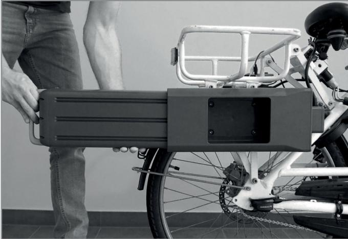
Sobald die Hinterseite des eBike Akkus 2.0 in die Aufnahme am eBike eingeführt ist, drücken Sie mit dem Daumen den Schnapper nach unten und schieben Sie den Akku behutsam in die dafür vorgesehene Aussparung an der Aufnahme ein. Achten Sie darauf, dass der Schnapper in der Aussparung einrastet (siehe Bild unten). Zum Entnehmen ebenfalls den Schnapper nach unten drücken.
